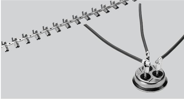
冷蔵庫、冷凍機、エアコンなどのコンプレッサー内に密封されたモータのリード線とクラスターピン(φ2.3mm)を接続する単極コネクタです。
