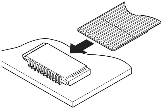
実装高さ1.2mmの薄型で省スペースを実現。標準FPC厚さ0.3mmに対応したNon-ZIFタイプのコネクタです。
