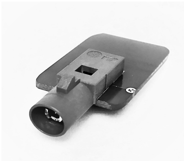
テレマティクスと車載コミュニケーション技術に適応した FAKRAとUSCAR規格に基づいた車載同軸コネクタ
