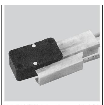
電気用品安全法に準拠したマイクロスイッチ用コネクタです。マイクロスイッチへの装着が軽く容易に行え、組立作業の合理化がはかれます。また、コンタクトをハウジングに装着する際、誤挿入を防止できる構造で、装着しやすくハーネス加工の作業性が向上します。
