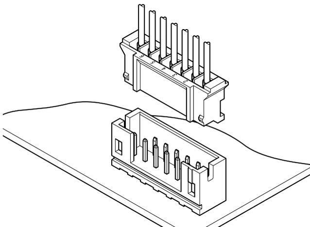
実装高さ 8.0mm、厚さ 4.5mm。内部配線の高密度化の要求に応じて開発した薄型、ロー・プロファイルの電線対プリント基板接続用の 2.0mm ピッチコネクタです。
