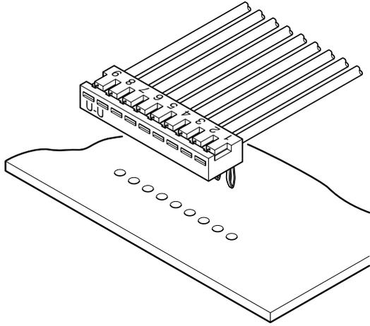
ピッチ2.0mm、実装高さ2.8mm、厚さ4.9mmの低背小型設計、圧着・サイド型基板直付タイプのコネクタです。
