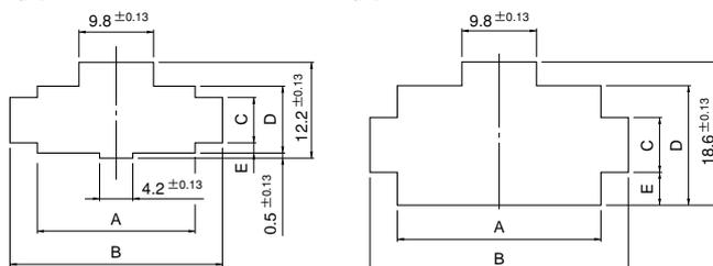
注1) 上図の形状寸法通り、ばりなどができないように穴あけ加工してください。
