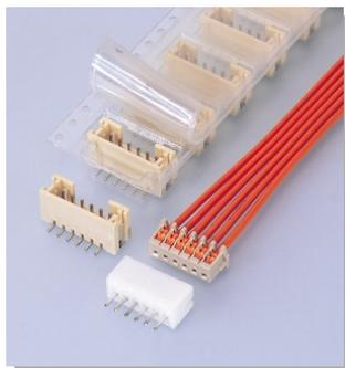
電気用品安全法に規定される機器等の内部配線に使用されるUL1007電線の接続を2.0mmピッチ圧接コネクタで可能にしました。実装高さ6.9mm、厚さ4.8mm(トップ型)の低背設計。
