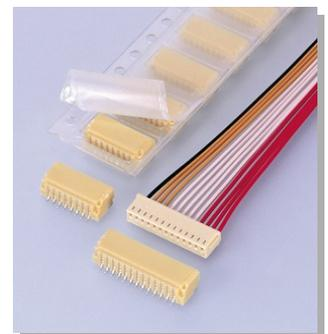
基板対電線用の1.0mmピッチで初の圧接方式を採用。従来品に比べ約61%の小型化を実現しました。ツインUスロット、3点グリッパ構造などにより優れた接続性能を発揮します。
