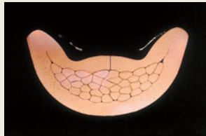
▲撚線の圧着断面
