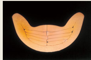
▲平角線の圧着断面
