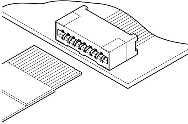
1.0mmピッチFFC 接続に対応したSMTタイプのコネクタです。実装高さ2.8mmのコンパクト設計。両面接続リーフコンタクト採用により、リード部導体面の配慮を必要とせず、実装設計が容易です。自動実装に対応したエンボステーピング供給が可能です。
