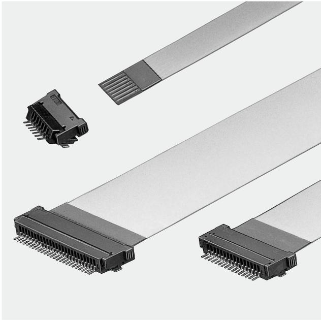
リードピッチ 1.0mmのFFC接続に対応したZIFタイプの表面実装用コネクタです。嵌合部スライダにガイド機能をもたせ、ワンタッチでしかも確実な接続を可能にしました。また、表面実装に最適な耐熱設計で自動実装に対応したエンボステーピング供給が可能です。
