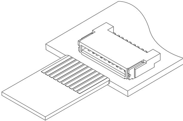
0.4mmピッチを採用し実装高さ1.0mm、
