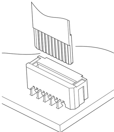
0.4mmピッチを採用したトップタイプで、実装高さ2.5mmの低背 Non-ZIF タイプコネクタ。
