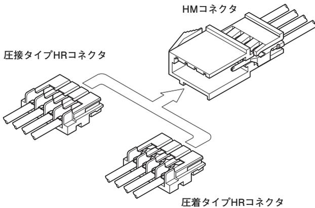
圧着と圧接の両タイプHRコネクタ(ソケット)と嵌合するプラグ形の2.5mmピッチ電線対電線接続用コネクタです。デリバリー、コスト、品質と信頼性に優れたHRコネクタの適用によりワイヤーハーネスの標準化が図り易くなります。
