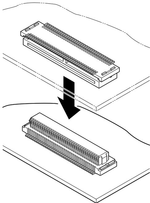
SMT対応、0.4mmピッチ、平行接続の基板対基板用コネクタです。
