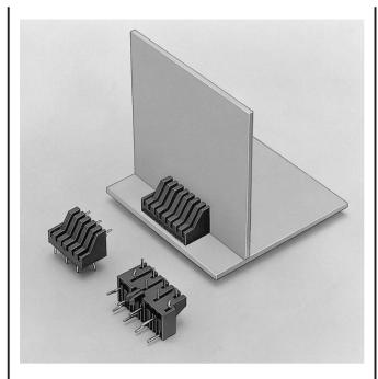
プリント基板対プリント基板の直付接続用2.5mmピッチへッダーです。はんだクラック対策等に優れた千鳥配列を採用し、耐久性と自立性を高めたテーピング仕様、供給品です。
