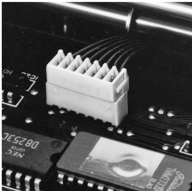
電線の被覆をむくことなく、コネクタ本体のコンタクトと電線を接続する圧接方式のプリント基板用コネクタで、当社の圧接シリーズのオリジナル製品であり、多くの実績と高い信頼性があります。また、NRコネクタはコネクタ本体（ソケット）とベース付ポストで構成され、ソケットは使用する電線サイズごとに色別（AWG#28緑、AWG#26ナチュラル、AWG#24黒）され、ディスクリットワイヤ（単心線）およびリボンケーブルを使用することができます。
