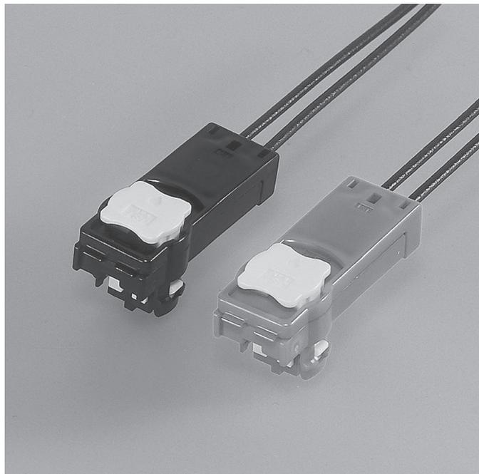
インテリジェントCPAを採用し、コネクタ嵌合ロック、不完全嵌合検知、ショート回路の解除を同時に行う機構を実現したエアバック用コネクタです。
