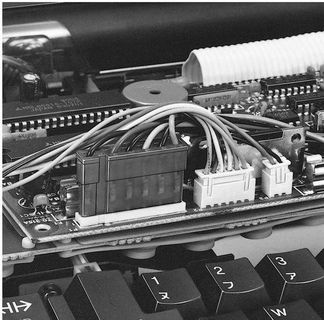
プリント基板と電線を接続するための多極コネクタで、コンタクト、ハウジング、ベース付ピンにより構成されています。極数は2～6極で、そのうち1極は7.5mmピッチ、他の極は5mmピッチとなっており、ハウジングとベースピンを組み合わせるときの逆接続を防止する構造になっています。
