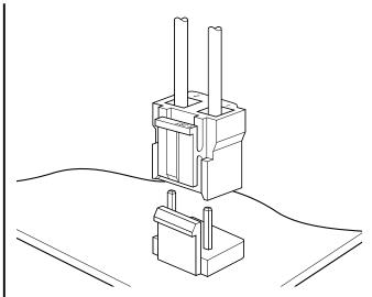
1 次側電源回路をはじめ、広範囲な回路に対し、余裕 ある接続性能をもつ 7.92mm ピッチ圧着・嵌合タイプ コネクタです。誤挿入防止構造をはじめ、確実なロック 機構など安全性に優れたコネクタです。
