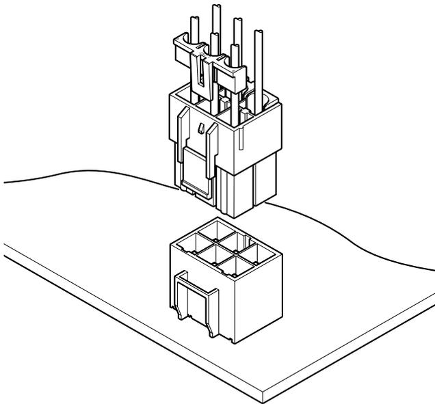
大電流に対応した6.2mmピッチ電線対電線接続および電線対プリント基板接続の2種類の接続に対応したコネクタです。コンタクトの不完全挿入、抜けを防止するリテーナが使用でき、大電流回路を安全に確実に接続します。
