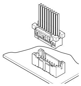
2.5mm ピッチ、圧着タイプ、グリッド (二列) 構造を採用した、 強ロック付基板対電線接続用コネクタです。
