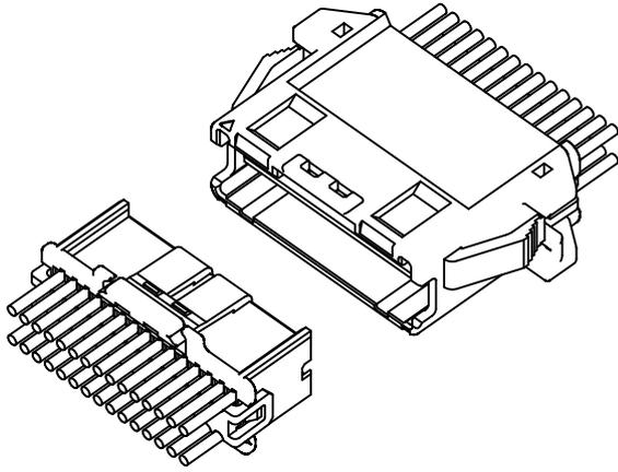
高密度な機器設計に対応した 1.5mm ピッチ 2 列強ロック仕様の電線対電線接続用コネクタです。良好な嵌合フィーリングにより不完全嵌合の発生を抑制します。
