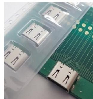
USB Type-C に準拠したインターフェースコネクタで、最大 100W の電力供給が可能です。リセプタクルはデータ伝送速度が最大480Mbps の伝送が可能な 16 ピン仕様です。プラグの表裏を気にせず挿入可能なりバーシブル構造です。
