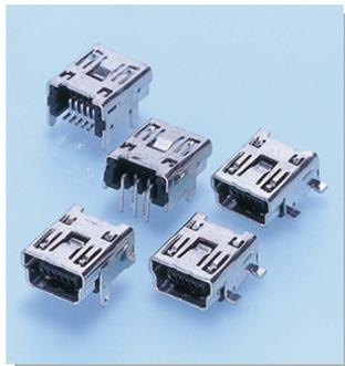
USB 2.0 規格準拠のリセプタクルです。デジタルカメラ、MP3 プレーヤー等の小型・薄型周辺機器の外部インターフェイスに最適です。
