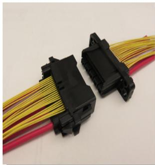
ユニット接続におけるハイブリッドタイプのドロワーコネクタです。ユニット間のずれ吸収機能を持ち、プラグ側はパネルロックでの取り付けが可能です。挿抜回数の少ない箇所に最適なドロワーコネクタです。
