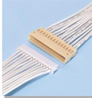
圧着・圧接両タイプのソケットと嵌合する小型省スペースの1.5mmピッチ電線対電線接続用コネクタです。4面ボックス形状で挿抜時のこじりなどのイレギュラーな外力に対して強い構造になっています。
