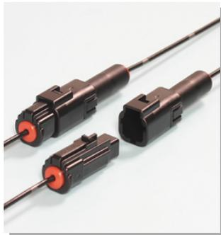
特に防水性を要求される箇所での使用に最適な中継接続用コネクタです。パワー系でありながらコンパクトで、JIS C0920保護等級7(防浸形)の防水性を有し、耐久性にも優れています。
