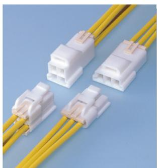
作業時の未嵌合防止機構として、プラグ・リセプタクルのハウジングロック突入時に生じる慣性力を利用し、最終嵌合位置まで嵌合させる機構を採用しました。
