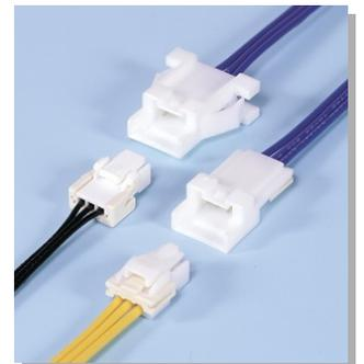
2.0mmピッチ強ロック付コネクタ群のPAファミリーにおける電線対電線用のプラグ型圧着コネクタで、圧着タイプのPAコネクタと圧接タイプのPAFコネクタのそれぞれソケットと嵌合します。リテーナが装着可能なパネルロックとフリーハンギングの2タイプをラインアップしています。
