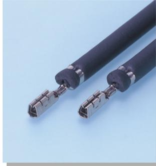
ガス給湯器、ファンヒータなどの点火プラグ(プラグピン 2.0)との接続に用いられる接続子です。容易な作業で確実な接続が可能で、メンテナンスも簡単です。3つに分かれた嵌合部パネにより、常に安定した電氣的・機械的接触が得られ、こじり挿抜に強い構造です。
