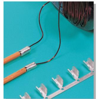
この接続子はSPC接続子と同じ用途ですが、接続子内部に特殊チャンネル加工を施しており、巻線(エナメル線、ホルマル線など)の場合、絶縁被覆をあらかじめ剥離しないで良好な電気接続が行えるよう設計された接続子です。モータ、リレー、その他回転機の巻線相互間の接続及び巻線とリード線の接続に適しています。
