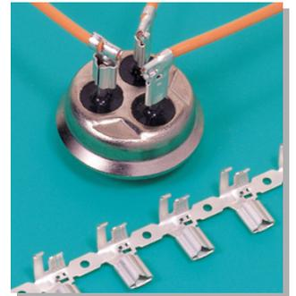
冷蔵庫・冷凍機・エアコンなどのコンプレッサー内に密封されたモーターのリード線とクラスターピン( 2.3mm)を接続する単極コネクタです。りん青銅にすずめっき仕上げしたもので、安定した接触性能を維持する高信頼性のコネクタです。
