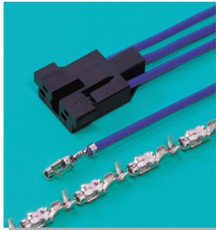
冷蔵庫・冷凍機などのコンプレッサー内に密封されたモーターのリード線とクラスターピン( 2.3mm)を接続する3極用コネクタです。耐熱性及び耐久性を特に要求されるため、コンタクト、ハウジングともにこれらを十分に配慮した設計と高品質の材料で構成されています。
