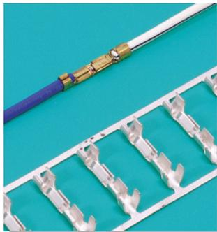
冷蔵庫・冷凍ケースなどの霜取り用ヒータ線(心線をラセン状に巻いたもの)とビニル電線との接続に用いる接続子です。ヒーター線を傷つけたり、切断しないようにふた構造のパレルを採用しており、信頼性の高い安定した接続ができます。
