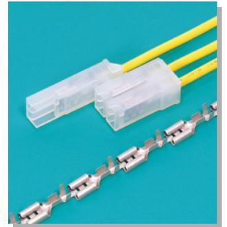
電気用品安全法に準拠したマイクロスイッチ用コネクタです。マイクロスイッチへの装着が軽く容易に行え、組立作業の合理化が計れます。また、コンタクトをハウジングへ装着する際、誤挿入を防止できる構造で、装着しやすくハーネス加工の作業性が向上します。
