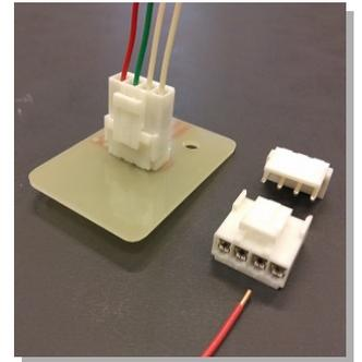
多様な電気電子機器での使用実績が豊富なVHコネクタの単線用速結タイプです。単線をストリップ加工してソケットに挿し込むだけでハーネスが製作できるため、機器設置現場での電氣的接続作業に最適です。
