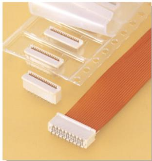
実装高さ4.15mm、スナップイン作業のできる、Non-ZIFタイプトップ型のFPC接続用コネクタです。
