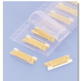
実装高さ1.2mmの低背を実現した、端末部(リード部)厚さ0.3mmの標準FPCに対応する、0.5mmピッチFPC接続用コネクタです。FPC挿抜寿命の向上に有効なZIF方式を採用しています。
