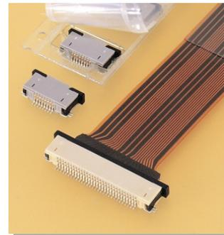
実装高さ2mm、ピッチ0.5mmのコンパクトなFFC/FPC接続用コネクタです。耐摩耗性、挿抜寿命の向上に有効なZIF方式を採用しています。ノーマル(上接点)とリバース(下接点)の2タイプを揃え、機器設計の自由度の拡大に貢献します。
