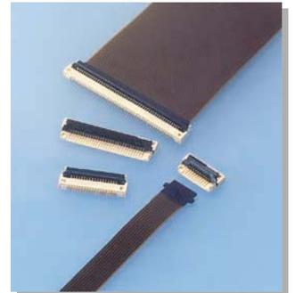
実装高さ1.3mm、FPC厚さ0.3mmのFPC接続用コネクタです。つば付きFPCを採用することによりFPC未嵌合・誤挿入を防止し、接続信頼性が向上します。
