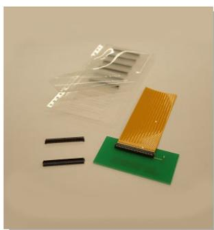
FPC厚さ0.3mmに対応した0.5mmピッチ・バックフリップタイプのFPC接続用コネクタです。実装高さ1.0mm薄型で省スペースを実現。Thunderbolt™等の各種高速インターフェイスの伝送を考慮し、特性インピーダンス差動90°&Omega;に整合しています。
